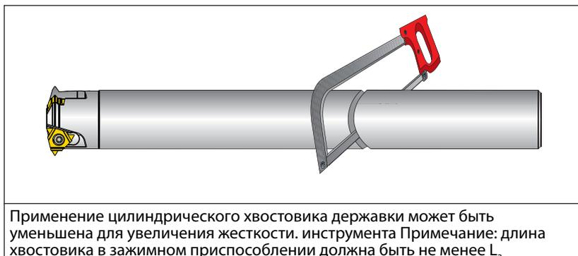
Применение цилиндрического хвостовика державки может быть уменьшена для увеличения жесткости инструмента. Примечание: длина хвостовика в зажимном приспособлении должна быть не менее L<sub>3</sub>.
