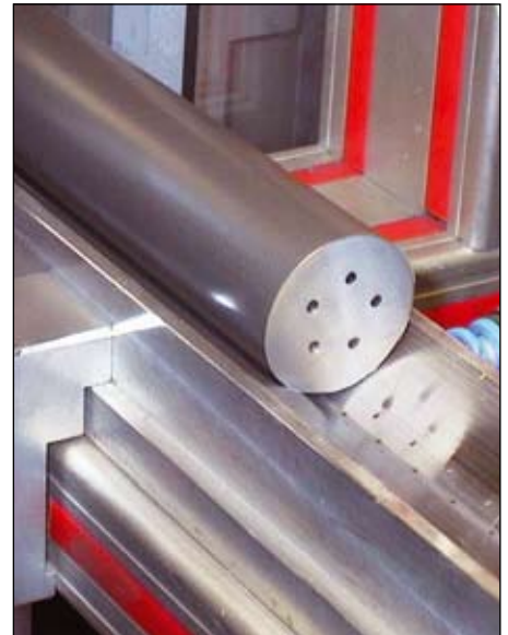
Strangpresse zur Herstellung von Hartmetallstäben mit Kühlkanälen. Extrusion press for the production of carbide rod with coolant ducts.
